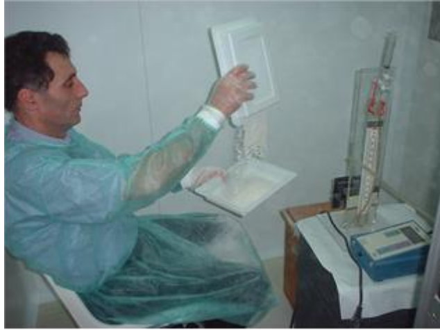
Figura: Cámara dinámica de exposición alérgenos ocupacionales
